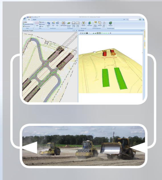
Abb. rechts: Übersicht bei der Produktionssteuerung. Etwa als Maschinensteuerung im Straßenbau oder als Fertigung von Bauteilen aus der Modellgeometrie heraus.
